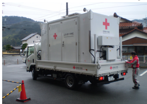
自動昇降コンテナとトラック
